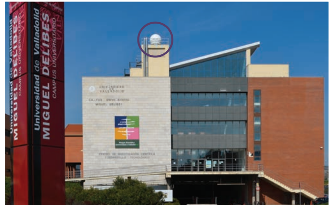
西班牙巴利亚多利德大学的Dartcom X波段EOS系统，天线系统(圆圈中物体)安装在电梯轴上
