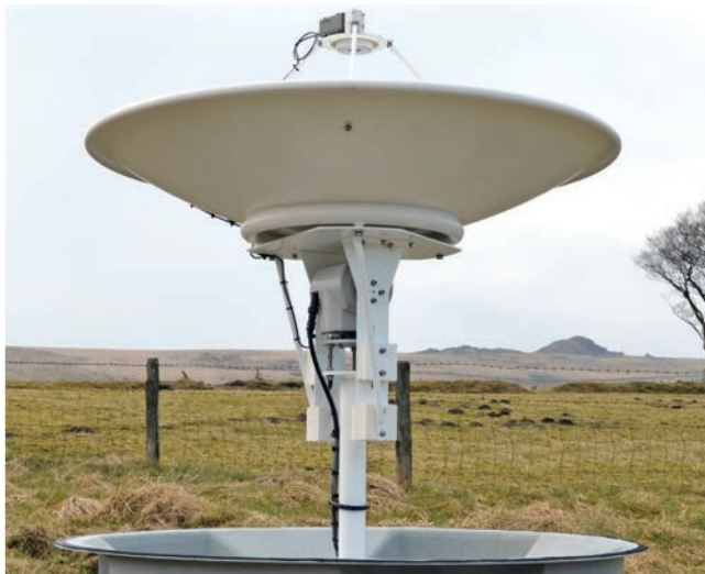
拆除天线罩后的1.5米抛物线碟状天线，标量馈电喇叭和LNB
